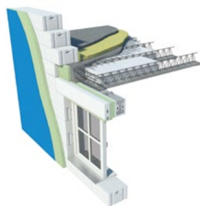
Vizualizácia skladby nosných a nenosných prekladov pri hrúbke steny 375 mm.
